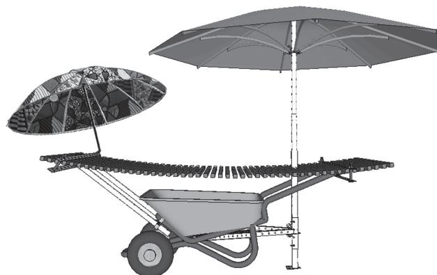
Un parasol standard est emboîté dans le mât télescopique et il peut être complété par un parapluie récupéré.
