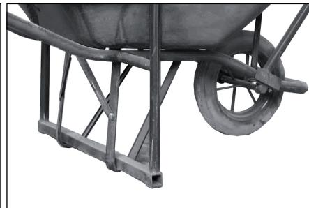
Augmentation de la stabilité au sol grâce à l'ajout d'un tube carré transversal/ sert également de support aux tubes latéraux, pour fixer le auvent.
