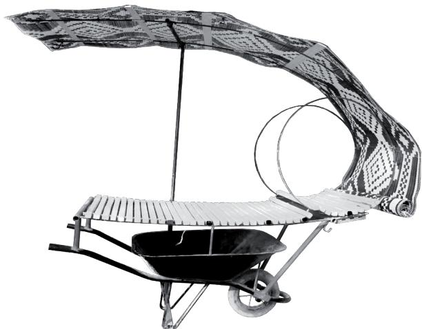
Système de déroulé du auvent en clayette, bambous, roseaux typha, canisses ou natte tissée.
