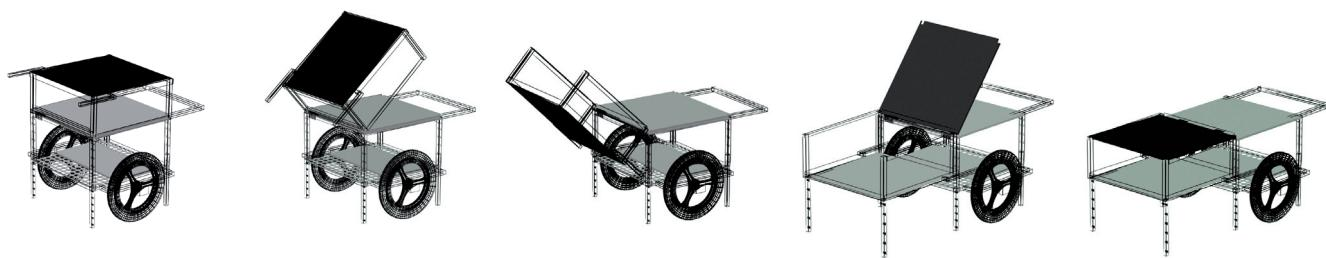
Le cube est divisé en 2 parties pour un déploiement maximum à l'horizontale ou un effet-coffre. Tous les éléments-outils et petits équipements sont rangés, dans la plate-forme agencée à la base du chariot. Les deux niveaux sont ergonomiques : Les tablettes s'augmentent par glissière ou rotation (ici grâce à des charnières). Les appareils et contenants s'encastrent dans les planches.
